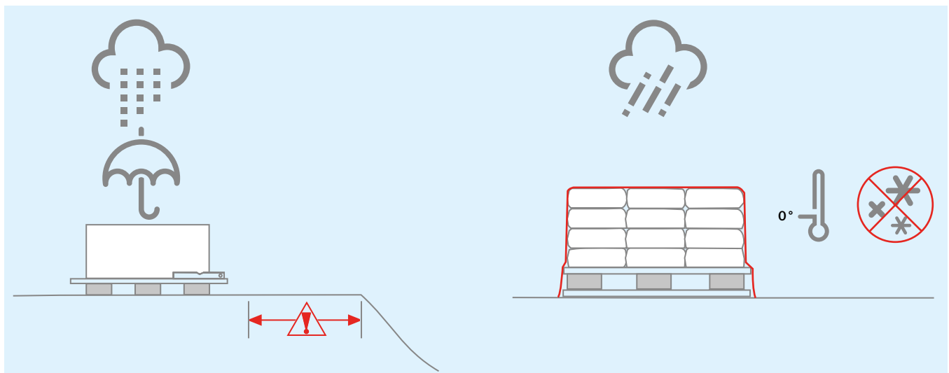
Bild 6 Die Lagerung von Steinen und Mörtel erfolgt witterungsgeschützt auf tragfähigem, ebenem Untergrund.
