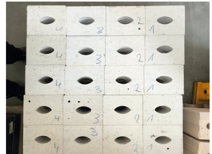
Kalksandsteinmuster mit Sägeschlamm aus den Werksversuchen.
