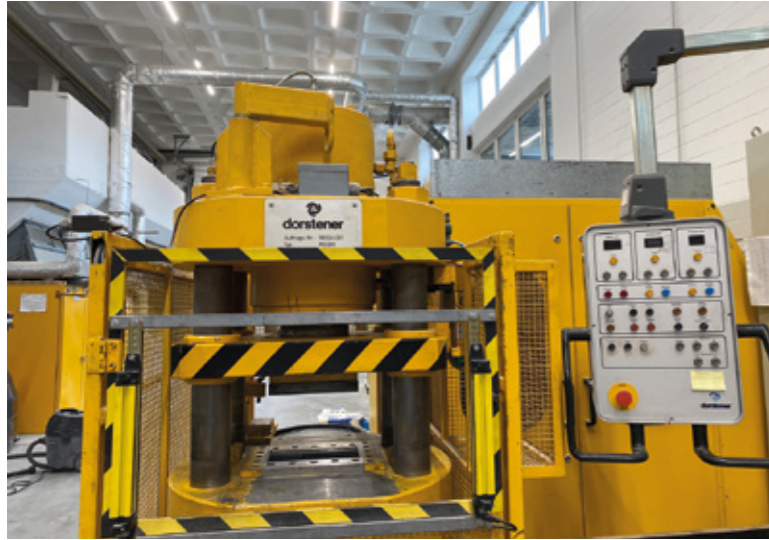
Kalksandsteinpresse im Technikum Hannover zur Verdichtung von Rohmischungen.
