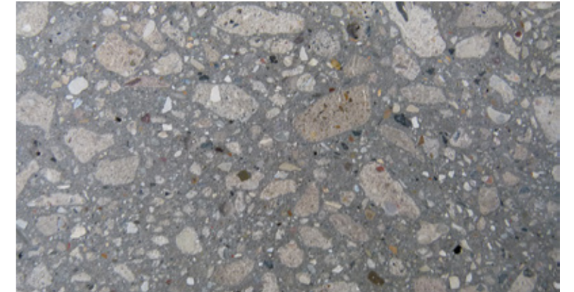
Beton mit rezykliertem Kalksandsteinanteil kommt mit weniger klimaschädlichem Zement aus, weil die CSH-Phasen des Kalksandsteins über ähnliche Stoffeigenschaften verfügen.
