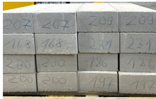
Funktionsmuster aus den Werksversuchen, Beispiel: Zugabe von rund 2 Masse-% an Calciniertem Ton.
