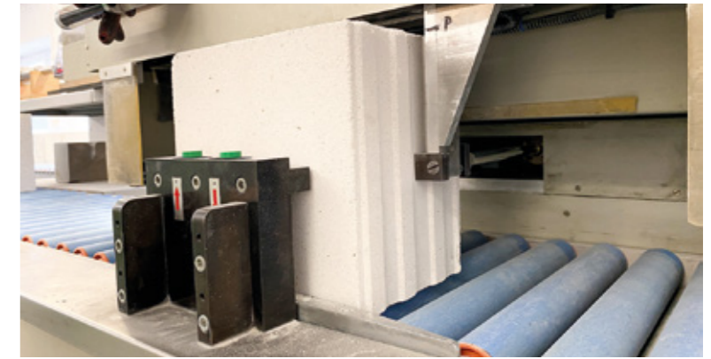
Automatische Vermessung der Kalksandsteinmuster mit Sägeschlämmen als Optimierungszusatz.
