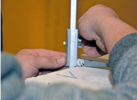
Bild 8 Kalksandsteine sind sehr maßgenau.
