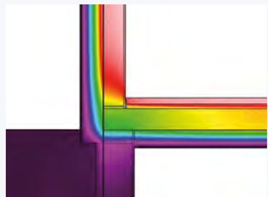
Temperaturverlauf einer Tiefgaragendecke aus DIN 4108 Beiblatt 2.
