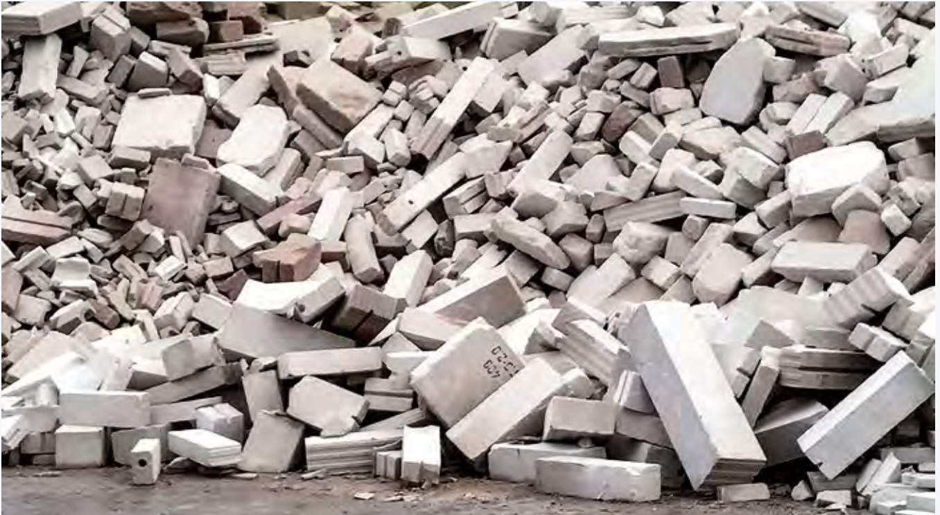
Sortenreiner Kalksandsteinbruch ist das Ausgangsmaterial für Recycling-Füller.
