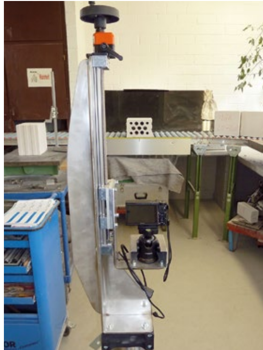
Vermessung des Lochbilds eines Kalksandsteins.
