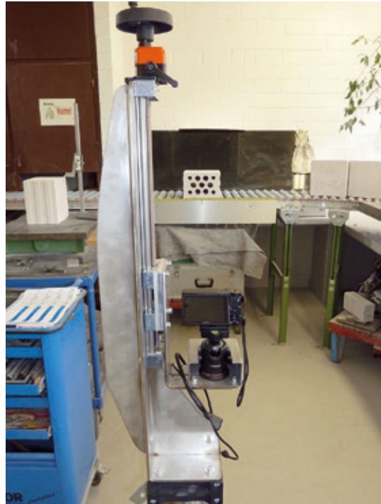
Lochbildvermessung eines Kalksandsteins.
