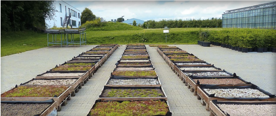
Bild 6 Freilandversuche zur Eignung von Mauerwerk-Recycling-Material für Dachbegrünungen der Fachhochschule Erfurt
